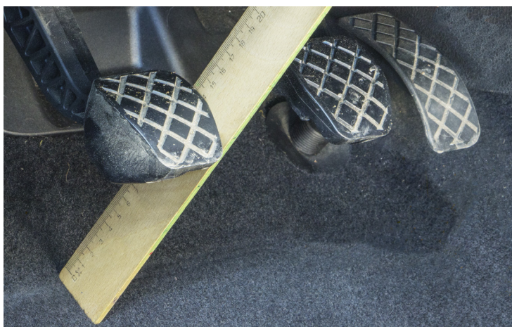
Рис. 1: После замены сцепления отрегулируйте ход педали.
