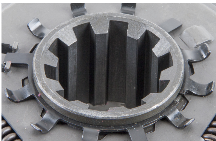
Рис. 2: Фосфатированные ступицы необходимо смазывать
