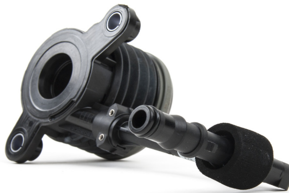
Рис. 2: Гидравлический выжимной подшипник с большим соединителем
