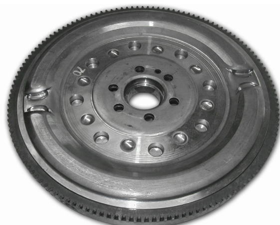
Рисунок 2: Двухмассовый маховик Sachs без кромки на внешнем радиусе
