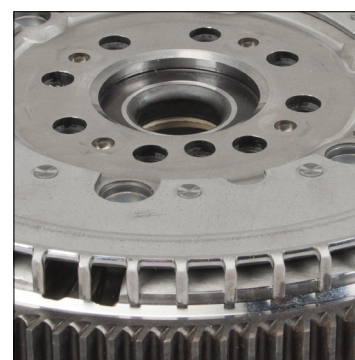
Рисунок 2: Новая конструкция сенсорного кольца
