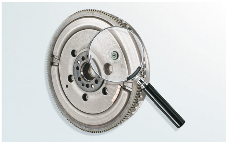
Рис. 1: Транспортировочный стопор остается в маховике.
