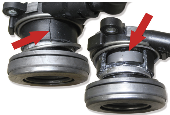
Рисунок 5: CSC поврежден в результате неправильной установки
