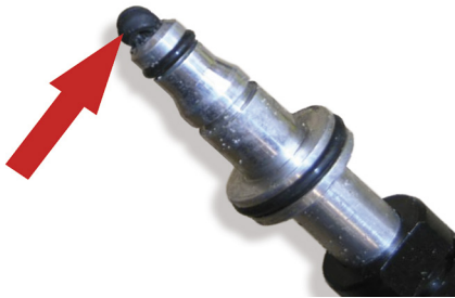
Рисунок 4: Если старое уплотнение не снять, то его вдавливают в новый CSC и блокирует трубку.
