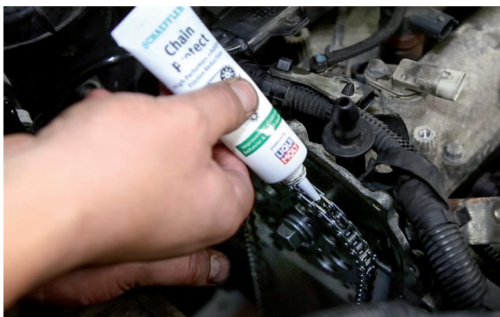
Рис. 2: Schaeffler Chain Protect применима для всех цепных приводов и их компонентов во время установки.
