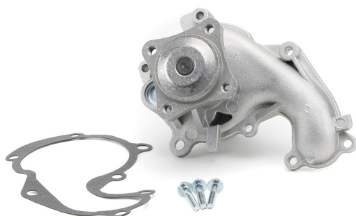
Рис. 1: Содержимое комплекта насоса. Увеличившаяся толщина кронштейнов требует применения более длинных болтов.
