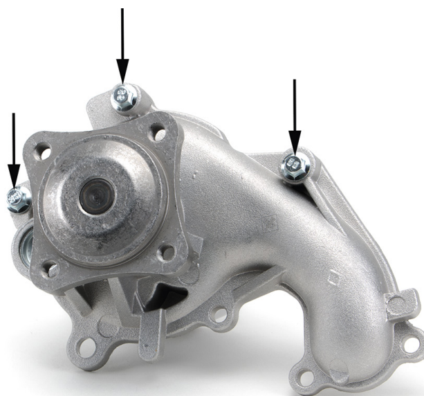
Рис. 2: Измененные кронштейны креплений водяного насоса
