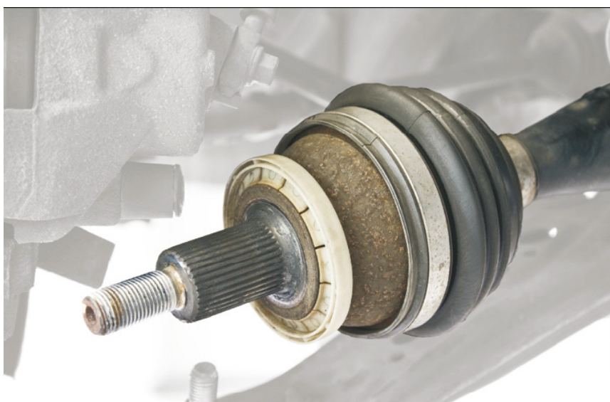
Рис. 1: Сальники могут отличаться по конструкции и цвету!
